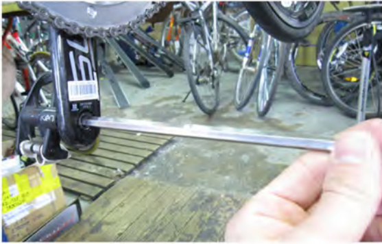
Immagine 15: Senso d'avvitamento dei pedali
